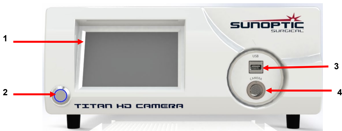
Figura 1 - Pannello anteriore della console della telecamera
